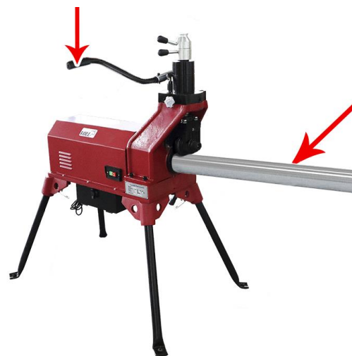
Рис. 7 Нажмите на трубу, когда силовой привод работает в режиме REV
